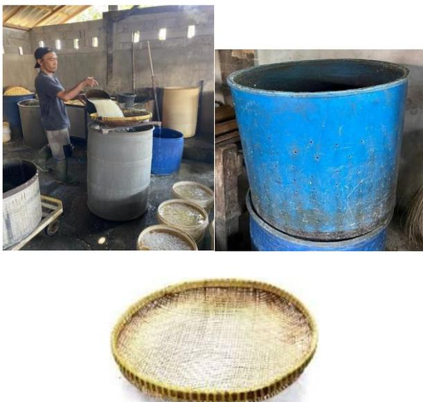
Gambar 2. Alat dan proses penyaringan kondisi eksisting
